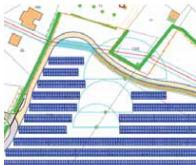
Zone d'ombrage évitée sur la partie nord
