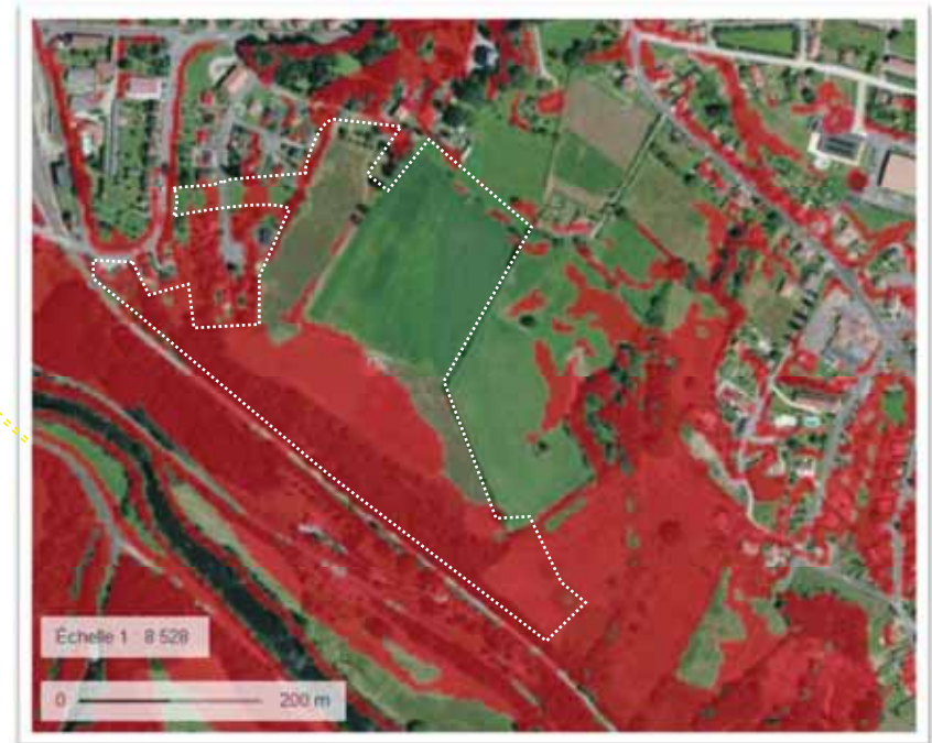
Illustration 31 : zones de pentes de plus de 10% (source : géoportail) et abrupt surplombant la voie ferrée (en pointillés jaune)
