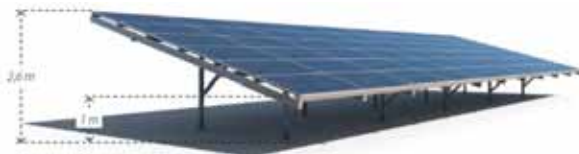
Figure 1 : Structure photovoltaïque envisagée sur le projet
