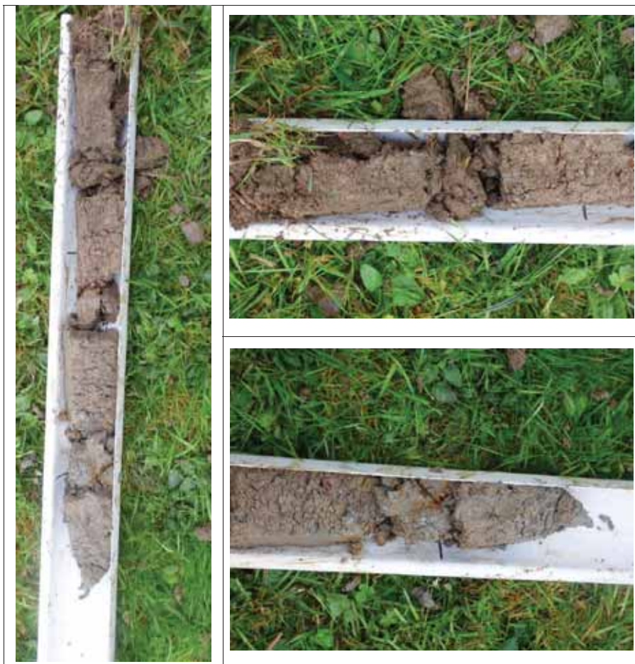
Sondage n°11, typique de sol de zones humides, avec la présence de taches d'oxydation dès 5 cm, s'intensifiant en profondeur et s'accompagnant d'une déferrification
